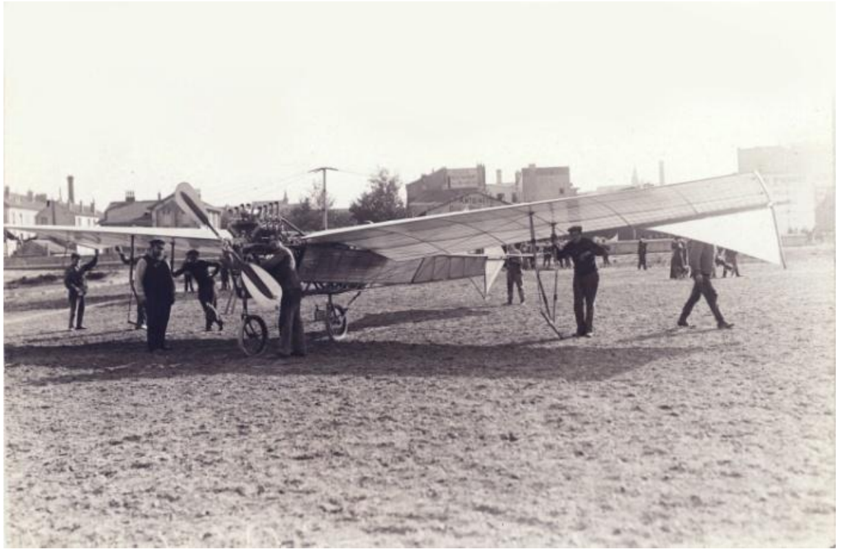
El Antoinette IV con tren de aterrizaje en tándem llevado desde la fábrica en Issy-les-Moulineaux hacia un lugar de prueba. Sobre el costado izquierdo de la fotografía se ve al Ing. León Levavasseur. Noviembre de 1908 9
